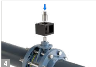
4 Instalar la torreta adaptador del motor y conexión eje motor. Install the actuator support adapter and the actuator shaft connection.
