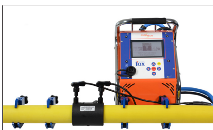
11. Inicio de la soldadura. Start welding.
