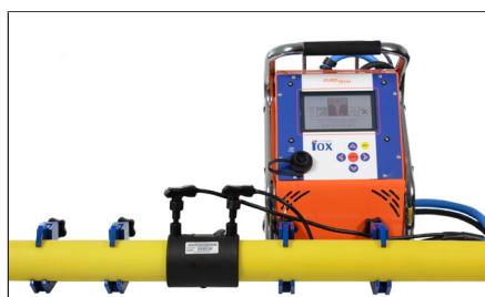
11. Inicio de la soldadura. Start welding.
