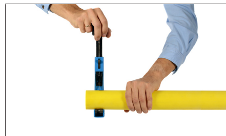
3. Cortar el tubo de forma totalmente recta. Cut the pipe straight.
